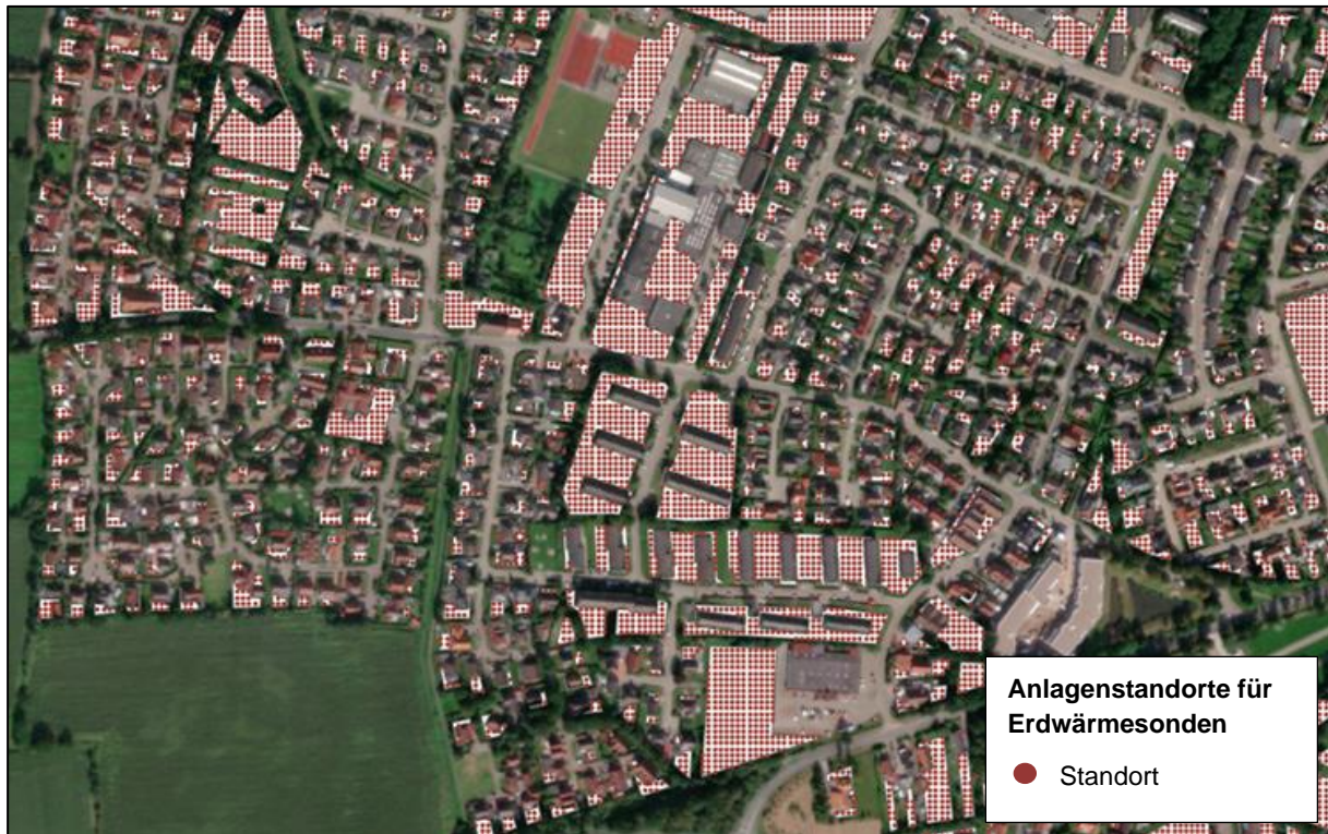
Abbildung 9-2: Standortermittlung für Erdwärmesonden am Beispiel der Stadt Wittmund. Berücksichtigung der Sondenabstände untereinander von 6 m und der Abstände zwischen Grundstücksgrenzen (hier Flurstücksgrenzen) von 10 m Entfernung (Quelle: IP SYSCON GmbH)
